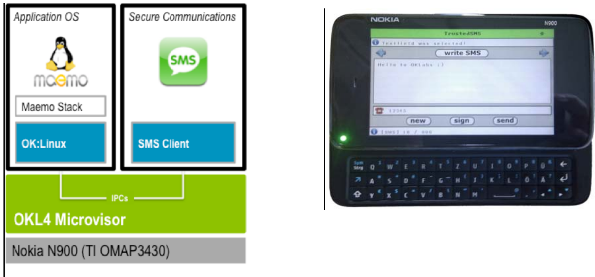
图5 —— 安全 SMS 架构和诺基亚N900上的SMS客户端截图
